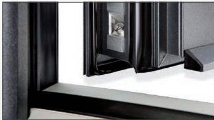
Stabile Eckverbindungen; Profile auf Gehrung verschraubt, verklebt und verbolzt
